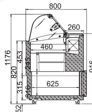
De 4 à 12 bacs de 5 L, le modèle TROPICAL est adapté aux usages intensifs et aux conditions extrêmes grâce à son groupe tropicalisé. Ce modèle existe en version vitres droites ou vitres bombées.
