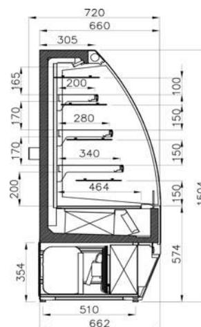
Semi-verticale, de profondeur réduite (662 mm), conçue pour la mise en valeur, la conservation et la vente des produits frais et des boissons. Des lignes arrondies et un faible encombrement au sol font de l'OPALINE SLIM, un outil particulièrement apprécié dans les petites surfaces de vente.
