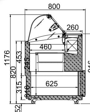
De 4 à 7 bacs de 5 L, le modèle TROPICAL est adapté aux usages intensifs et aux conditions extrêmes grâce à son groupe tropicalisé. Ce modèle bénéficie d'un double niveau de stockage de bacs à glace et d'une réserve réfrigérée.
